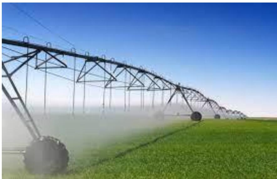
**Figure 2** : Système d'aspersion mécanisé : le pivot.
