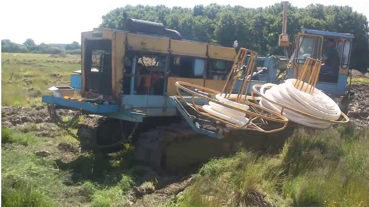
**Figure VII-1:** Photo de draineuse (Wikipédia)
