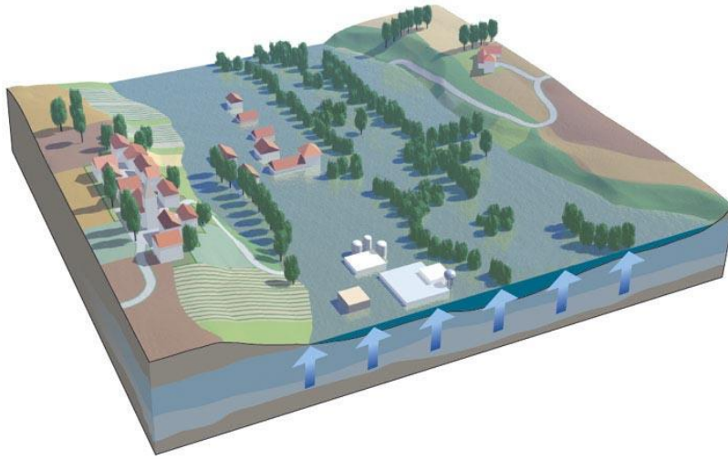
Figure I. 3 : Inondations par remontées des nappes phréatiques Source : epageloing.fr
